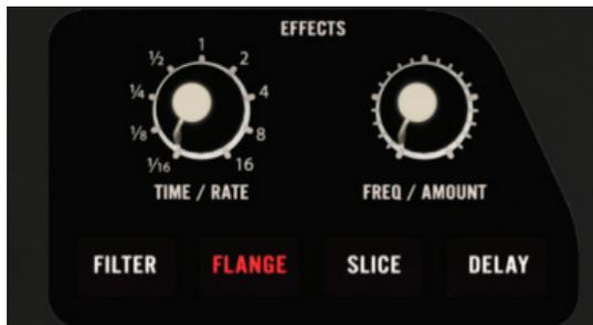
La SCS.4DJ comprend deux processeurs **EFFETS** (Platine A et B), et chacun a la capacité de traiter l'audio sur une seule platine. Les quatre **EFFETS** disponibles sont **FILTER**, **FLANGE**, **SLICE** et **DELAY**. Chaque bouton permet d'activer/désactiver l'effet sélectionné, ou de passer instantanément à un autre **EFFET** tout en désactivant l'effet en cours. Lorsque l'un des boutons **EFFECT** est appuyé, un témoin s'allume et l'effet est activé.
