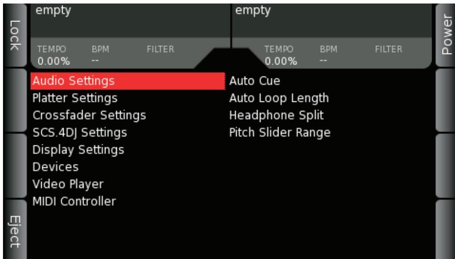
L'écran principal **MENU SYSTÈME** contient un volet à gauche et un volet à droite. Le volet gauche contient les huit principales catégories de paramètres. Le panneau de droite contient la liste des différents éléments de réglage de la catégorie sélectionnée. Le bouton Enter sélectionne le sous-menu. Lorsqu'un sous-menu est sélectionné, le contenu du volet de droite se déplace au dessus du volet de gauche.
